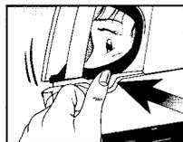
NOTA; tirare indietro la linguetta DeMistLock per chiudere completamente la visiera. Non è sufficiente abbassare la visiera. La richiusura deve essere effettuata mediante la linguetta DeMistLock.
