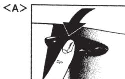
Tipo <B>; Le prese d'aria "Brow Vent" possono assumere la posizione completamente chiusa, intermedia o completamente aperta. A tal fine è sufficiente alzare il dispositivo di regolazione delle feritoie d'aerazione per aprirle o abbassarlo per chiuderle.
