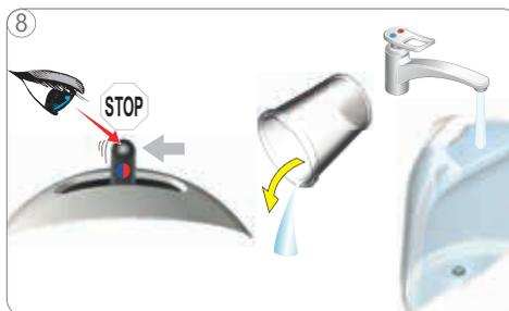
8 Attendere che la macchina torni al normale funzionamento. Rimuovere e svuotare il recipiente. Riempire il serbatoio della macchina con acqua potabile fino al livello massimo di contenenza.
