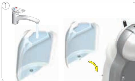
1 Risciacquare innanzitutto il serbatoio dell'acqua. Riempire il serbatoio con acqua potabile fresca. Posizionare il coperchio e inserire il serbatoio dell'acqua nella macchina.
