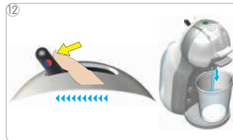
12 Spostare la leva verso sinistra per iniziare il risciacquo. Aspettare che la leva ritorni alla posizione iniziale e l'erogazione si fermi automaticamente.
