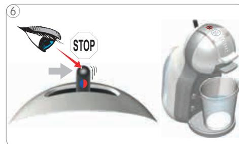
6 Aspettare che la leva ritorni alla posizione iniziale e l'erogazione si fermi automaticamente. La macchina smette di risciacquare e il pulsante di accensione e spegnimento lampeggia in rosso per circa 10 secondi.
