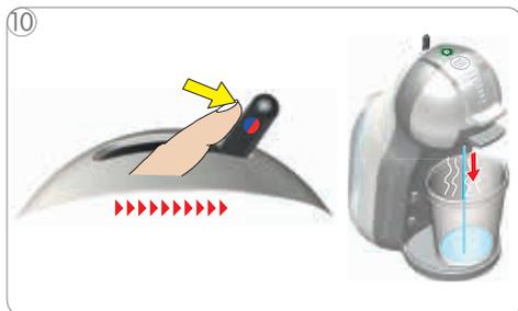
10 Spostare la leva verso destra per iniziare il risciacquo. Aspettare che la leva ritorni alla posizione iniziale e l'erogazione si fermi automaticamente.
