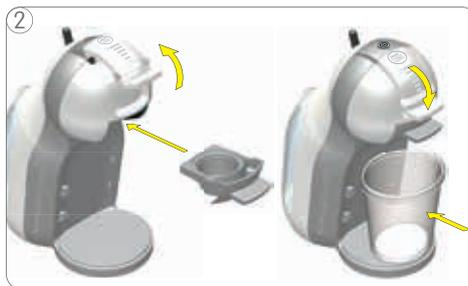
2 Aprire la leva di blocco e inserire il supporto per capsule vuote. Chiudere la leva di blocco. Collocare un recipiente vuoto da 1 litro sotto l'erogatore.
