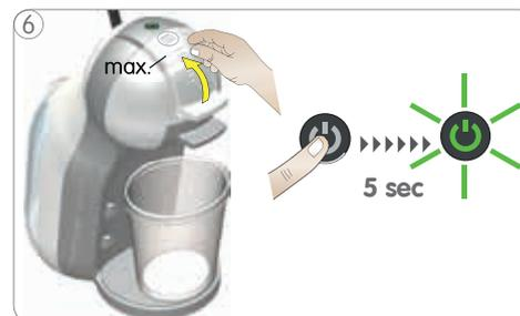
6 Spingere la barra di selezione dell'erogazione fino al livello massimo di tacche. Premere e mantenere premuto il pulsante di accensione e spegnimento per almeno 5 secondi. Il pulsante di accensione e spegnimento inizia a lampeggiare in verde e la macchina passa alla modalità di decalcificazione.
