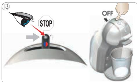
13 La leva torna nella posizione iniziale. Al termine del processo di risciacquo il bottone di accensione si illumina in rosso. Attendere che la macchina torni al normale funzionamento. Successivamente spegnere la macchina.
