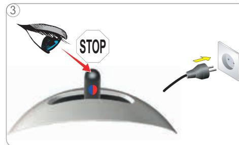
3 Verificare che la leva di selezione è in posizione di arresto. Allacciare in seguito la spina alla rete di alimentazione.
