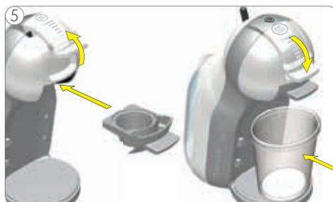
5 Aprire la leva di blocco e inserire il supporto per capsule vuote. Chiudere la maniglia di bloccaggio. Collocare un recipiente vuoto da 1 litro sotto l'erogatore.
