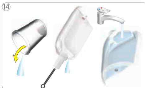
14 Svotare e pulire il recipiente. Risciacquare e pulire il serbatoio dell'acqua. Riempirlo in seguito con acqua potabile fresca e inserirlo nella macchina.
