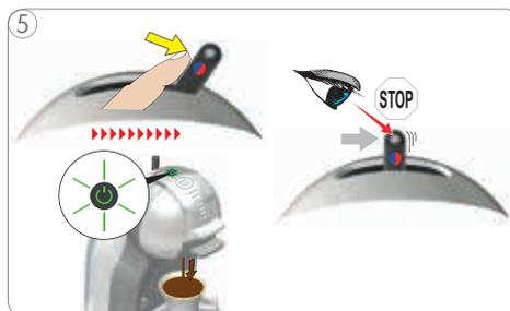
5 Muovere la leva verso destra per la preparazione di bevande calde, e verso sinistra per la creazione di bevande fredde. Aspettare che la leva ritorni alla posizione iniziale e l'erogazione si fermi automaticamente. Si può fermare l'estrazione manualmente, spostando la leva in posizione centrale.
