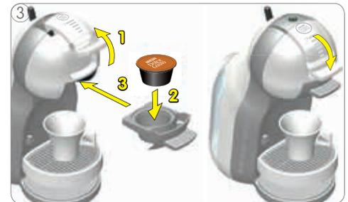
3 Aprire la leva di blocco ed estrarre il supporto per capsule. Inserire una capsula nel supporto e inserirlo nuovamente nella macchina. Chiudere la leva di blocco.
