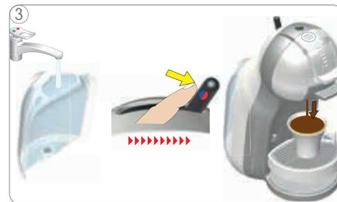
3 Controllare se c'è dell'acqua nel serbatoio: in caso negativo, riempire e spostare nuovamente la leva nella posizione freddo/caldo per proseguire la preparazione; se il serbatoio è pieno, procedere come segue:
