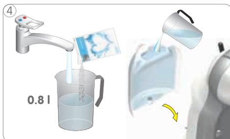
4 Mescolare 0,8 l di acqua con il contenuto di una busta di soluzione decalcificante liquida. Versare la soluzione decalcificante nel serbatoio dell'acqua e inserirlo nella macchina.
