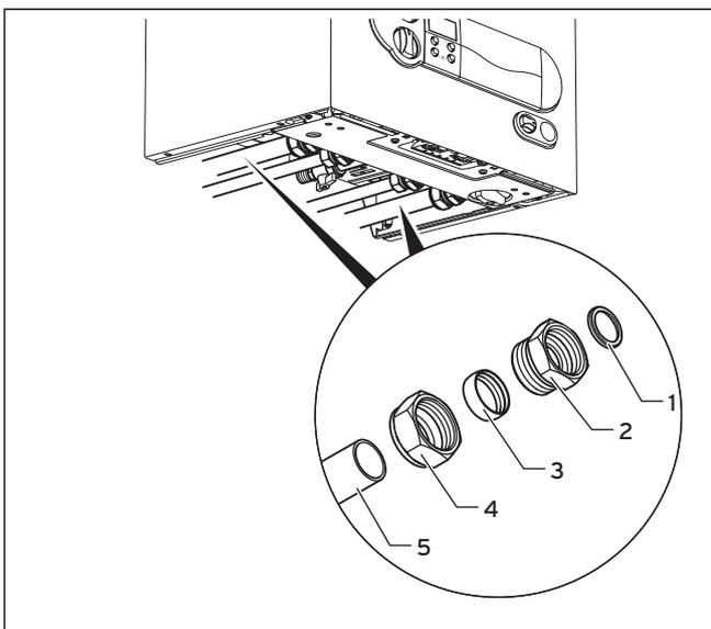
Fig. 5.3 Montaggio della mandata e del ritorno riscaldamento
