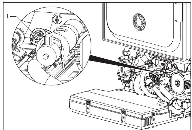
Fig. 7.3 Regolazione della valvola by-pass
