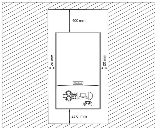
Fig. 4.3 Distanze minime richieste/spazio per il montaggio
