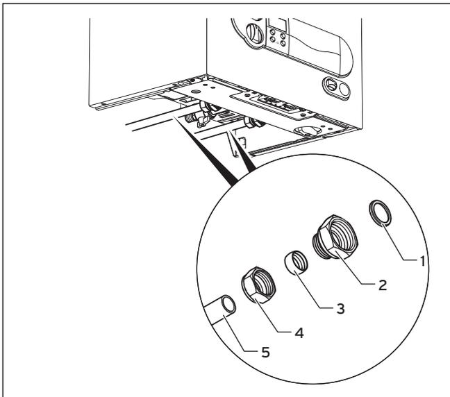
Fig. 5.2 Montaggio del raccordo acqua fredda e calda
