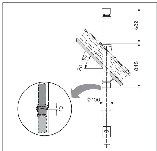
Fig. 5.4 Esempio di montaggio: passante verticale a tetto
