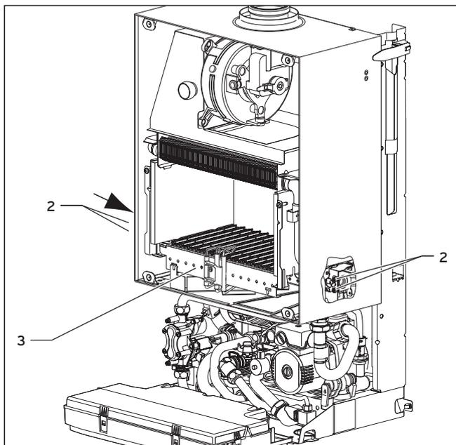
Fig. 8.3 Pulizia del bruciatore smontandolo (sporcizia tenace)
