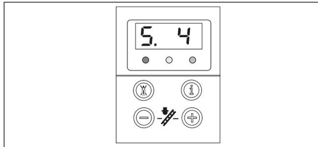
Fig. 9.1 Visualizzazione sul display con codice di stato
