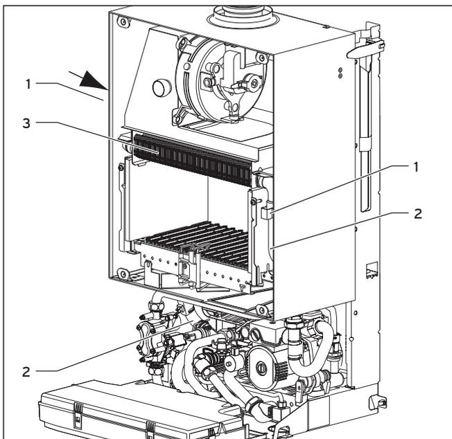
Fig. 8.2 Pulizia dello scambiatore termico primario smontandolo (sporcizia tenace)
