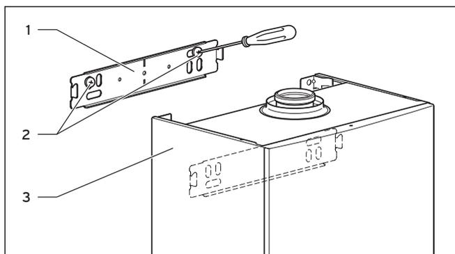
Fig. 4.5 Aggancio della caldaia
