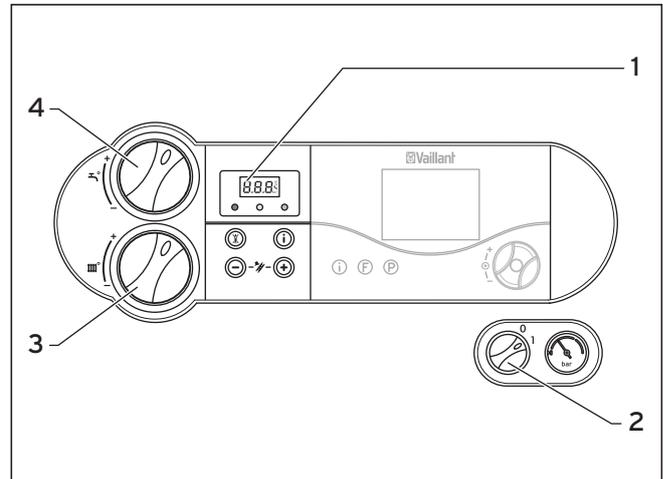
Fig. 6.2 Controllo della pressione di riempimento impianto riscaldamento
