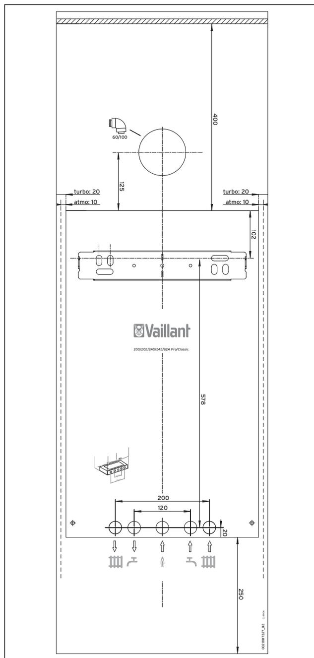
Fig. 4.4 Dima di montaggio
