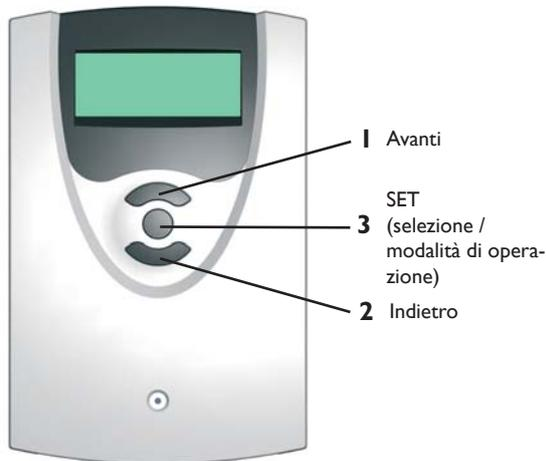
Il regolatore si comanda mediante i 3 pulsanti disposti sotto il visualizzatore. Il tasto 1 serve per scorrere (avanti) nel menu di visualizzazione o per aumentare valori di settaggio. Il tasto 2 corrisponde alla funzione contraria.
