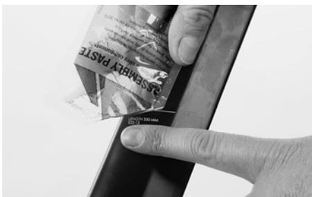
Applicare ora della pasta di montaggio Canyon sulla parte inferiore del reggisella e all'interno del piantone del telaio.
