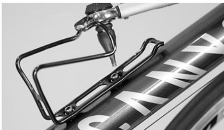
Nel caso del supporto borracce si attenga alla coppia di bloccaggio massima di 4,5 Nm
