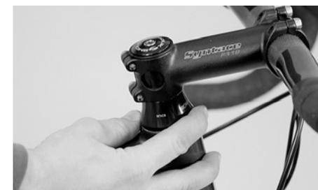
Verifichi il gioco della serie sterzo appoggiando un dito sulla calotta dello sterzo e spostando avanti ed indietro la Canyon con freno azionato
