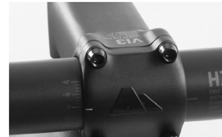
Negli attacchi manubrio Canyon la fessura superiore è completamente chiusa, mentre sarà visibile solo nella parte inferiore. Servendosi della chiave dinamometrica Canyon avvitare, se necessario, le viti di fissaggio. Non superare la coppia di serraggio massima!
