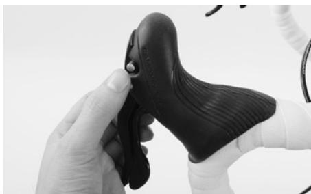
Richiudere subito la leva di sgancio veloce del freno (Shimano, SRAM) o ritrarre il perno della leva freno/cambio azionando leggermente la leva del freno (Campagnolo).
