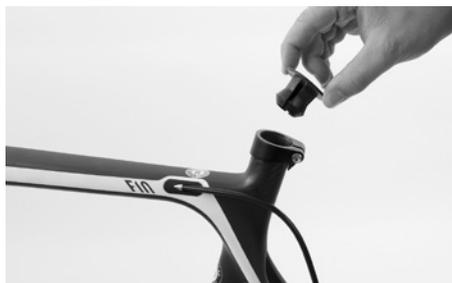
Rimuovere il cappuccio protettivo dall'estremità superiore del piantone. Allentare la vite sul bloccaggio rapido del reggisella. Leggere prima il capitolo "Regolazione della bicicletta da strada Canyon in base alle esigenze dell'utilizzatore" nel manuale "Bicicletta da strada" o nel CD allegato.
