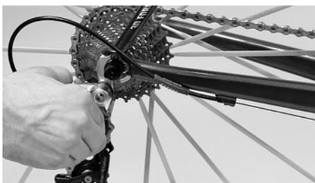
Accertarsi che il cambio posteriore non entri in contatto con i raggi quando la catena si trova sulla ruota dentata più grande. Premere attivamente contro il cambio per scongiurare la possibilità di collisione e fare girare lentamente la ruota.
