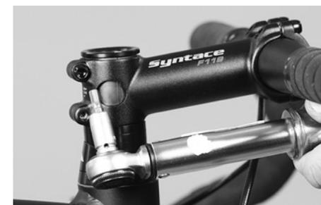
Verifichi le viti di fissaggio laterali dell'attacco manubrio servendosi di una chiave dinamometrica in base alle indicazioni stampate
