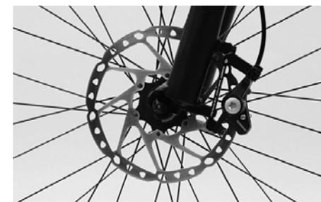
Nel caso di freni a disco, prima di montare la ruota, verificare se le pastiglie si trovano esattamente nelle predisposizioni della pinza freno. La fessura tra le pastiglie è parallela in tutte le sue parti e gli indicatori di usura si trovano nella posizione prevista. Assicuratevi che il disco del freno scorra tra le pastiglie.
