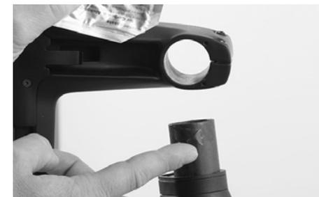
Svitare la vite dell'attacco manubrio rimuovendola insieme al tappo. Aprire un angolo della pasta di montaggio Canyon. Far uscire della pasta di montaggio e spalmare uno strato sottile sia sul lato interno del foro dell'attacco manubrio che sulle zone di bloccaggio del canotto della forcella.
