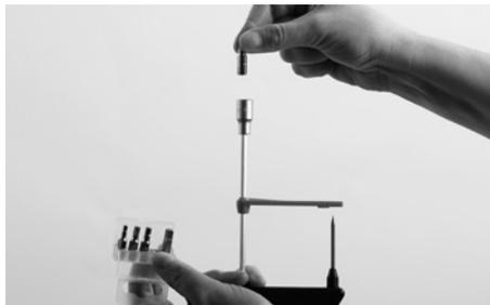
Inserire nel portautensile della chiave dinamometrica Canyon la punta adeguata.
