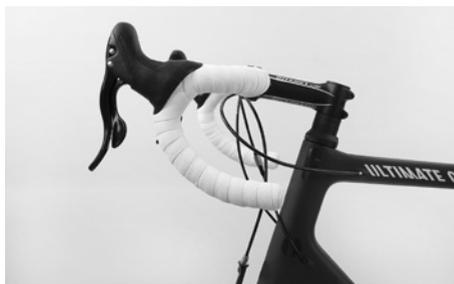
Controllare che le zone di bloccaggio delle leve freno/cambio siano posizionate orizzontalmente. Le zone terminali del tubo inferiore del manubrio sono orizzontali o leggermente rivolte verso il basso.
