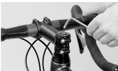
Dopo aver allentato le viti di bloccaggio laterali regoli il gioco dello sterzo con la vite di registrazione incassata in alto
