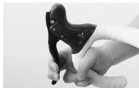
Tirare la leva del freno (più volte con freni a disco) dopo aver montato la ruota e chiuso il bloccaggio rapido. Controllare se il punto di pressione di entrambi i freni venga raggiunto contemporaneamente e sia immediatamente stabile.
