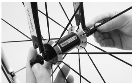
Montare la ruota anteriore spingendo il mozzo con bloccaggio rapido nel forcellino.
