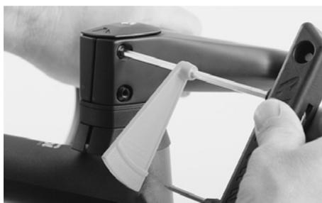
Inserire nel portautensile della chiave dinamometrica Canyon la punta adeguata. Per prima cosa avvitare leggermente e in modo uniforme le viti di fissaggio dell'attacco manubrio. Controllare che la fessura sia sempre uniforme. Per concludere, serrare le viti con una coppia di serraggio indicata (5 Nm).
