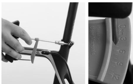
Girare lentamente tenendo la chiave dinamometrica Canyon dall'impugnatura. Quando la vite è serrata, l'indicatore sulla scala si sposta. Sospendere di girare la chiave non appena l'indicatore raggiunge il valore della coppia di serraggio prescritta.
