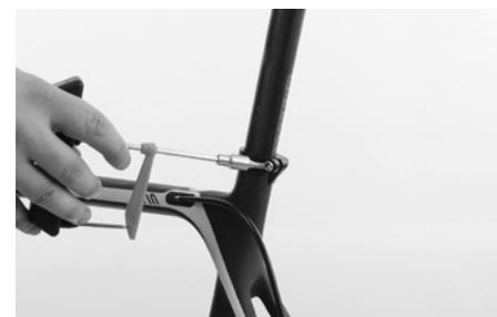
Regolare la sella e avvitare la vite sul bloccaggio rapido del reggisella senza serrare troppo, ovvero senza superare la coppia di serraggio consentita. Eseguire questa operazione utilizzando la chiave dinamometrica Canyon.
