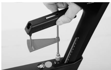
Serrare la vite ad esagono incassato della chiusura del reggisella con la coppia di serraggio indicata di 4-6 Nm (max).
