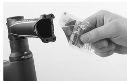
Aprire un angolo della pasta di montaggio Canyon. Far uscire della pasta di montaggio e spalmare uno strato sottile sia sul coperchio dell'attacco manubrio che sulle zone di bloccaggio del corpo stesso.
