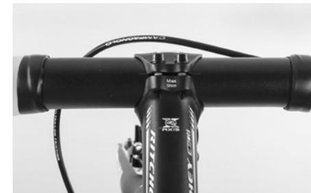
Avvitare le viti di serraggio del coperchio dell'attacco manubrio in modo alternato e uniforme fino a fissare leggermente il manubrio.
