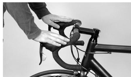
Verificare che il manubrio e le leve freno/cambio siano correttamente fissate. Cercare di ruotare le parti. Il manubrio non deve piegarsi verso il basso anche quando lo si spinge con forza. Se necessario, serrare con prudenza la o le viti di bloccaggio.
