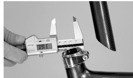
Verifichi che il reggisella sia perfettamente compatibile con il telaio
