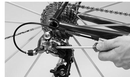
Si serva delle viti di regolazione dei fine corsa per limitare il raggio d'azione del cambio posteriore
