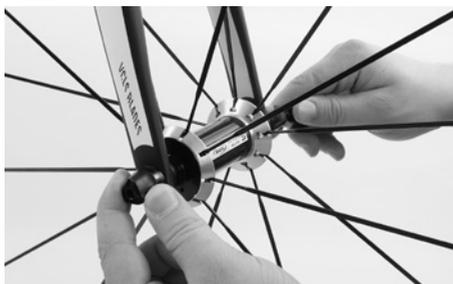
Avvitare il controdado del bloccaggio rapido aperto in modo tale che chiudendo la leva il bloccaggio rapido faccia presa. Fare attenzione che la leva, una volta chiusa, si dovrà trovare vicina alla forcella e non dovrà essere rivolta verso il lato e verso la parte anteriore.
