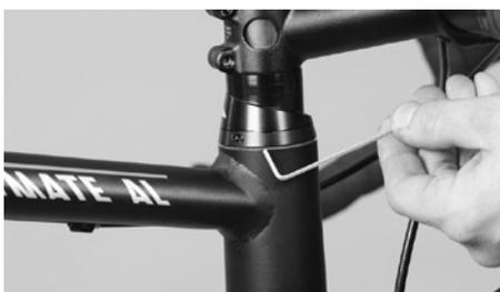
Riavviti la vite di registrazione della serie sterzo
