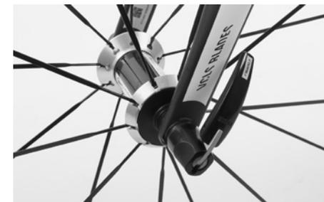
Controllare che la ruota anteriore sia stata completamente bloccata nel forcellino e che si trovi al centro tra i due foderi.
