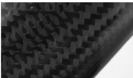
Controlli i componenti in carbonio con particolare attenzione ed, ai fini della sicurezza, provveda a sostituirli nel caso del minimo dubbio
