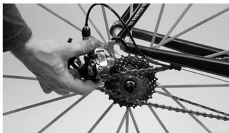
Spostare leggermente indietro il cambio posteriore per smontare la ruota posteriore
