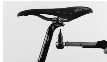
Avviti entrambe le viti progressivamente ed in senso alternato, non superi mai la coppia di bloccaggio massima consentita
