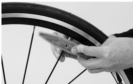
Montare anche i riflettori sui raggi. Assicurarsi di montare due riflettori uno per ciascun lato del raggio, sia sulla ruota anteriore che su quella posteriore.
