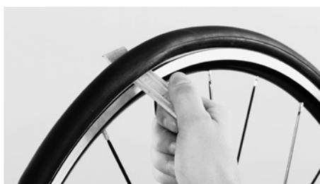
Con una leva di montaggio potrà staccare il tubolare
