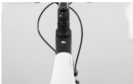
Controllare che la sella sia centrata. Osservare la sella guardando in direzione del tubo obliquo e orizzontale del telaio.
