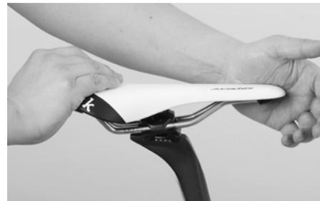
Verificare che il reggisella sia correttamente fissato. Cercare di ruotare le parti.
