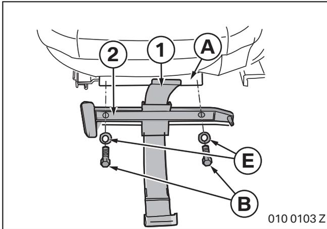
Infilare il perno di fissaggio della banda di fissaggio (1) nel foro del supporto per estintore (2).
