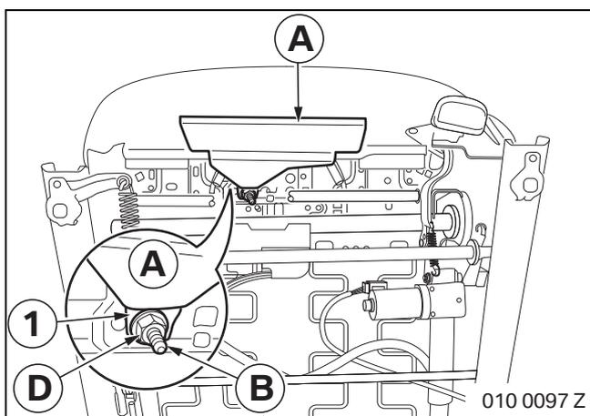
Fissare il punto di fissaggio posteriore (1) della squadra di fissaggio **A** con le viti a testa esagonale infilate prima **B** e i dadi esagonali **D**.
