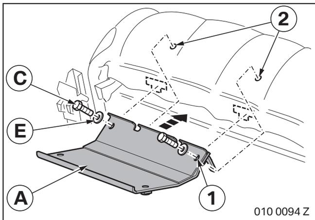
Introdurre la squadra di fissaggio **A** con i dadi da saldare (1) attraverso l'imbottitura del sedile.
