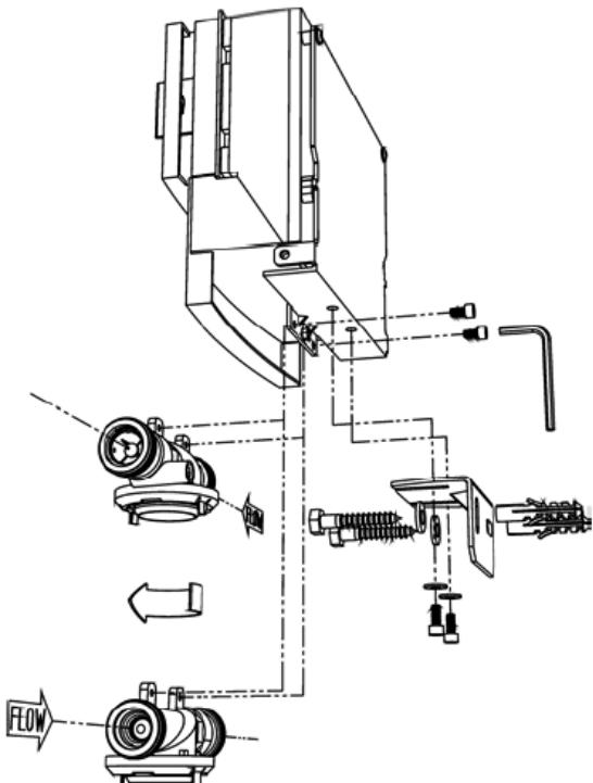
Importante: Osservare la freccia di flusso impressa sul modulo di allacciamento (L). Al momento della consegna l'apparecchio è configurato con direzione di flusso "da sinistra a destra". Se sul luogo di installazione si rendesse necessaria una direzione di flusso "da destra a sinistra", occorre girare il modulo di allacciamento (L) con l'ausilio della chiave a forchetta a esagono cavo nel modo seguente:
