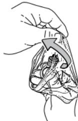
Nieuwe filterpatroon aan het bovenste kunststofgedeelte vastpakken en **met de hand** vastschroeven (max. 1,5 Nm).
