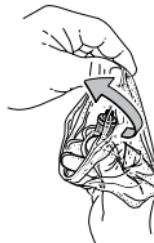
Afferrare la cartuccia filtrante nuova per il componente in plastica superiore e avvitare **manualmente** (max. 1,5 Nm).
