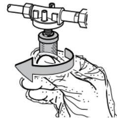
De gebruikte filterpatroon resp. het reinigingsmateriaal ter bescherming tegen geuren en oliën in de veiligheidshandschoen wikkelen.
