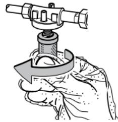
Afin de se protéger contre les odeurs et l'huile, envelopper la cartouche filtrante usagée ou le matériel de nettoyage dans le gant de protection.
