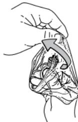
Neue Filterpatrone am oberen Kunststoffteil anfassen **und mit der Hand** einschrauben (max. 1,5 Nm).
