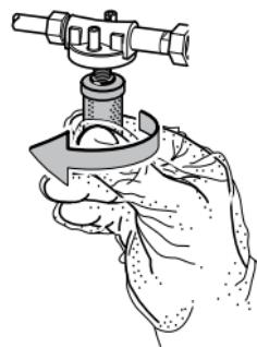
Den brugte filterpatron eller rengøringsmaterialet vikles ind i beskyttelseshandsken for at beskytte mod lugte og olie.
