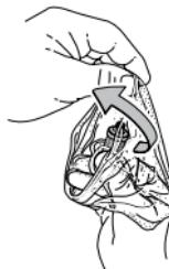
Sujetar el nuevo cartucho de filtro por la parte superior de plástico y enroscarlo **manualmente** (máx. 1,5 Nm)
