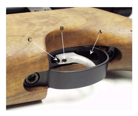
Ricordate che piccoli aggiustamenti produrranno un cambiamento notevole del funzionamento dello scatto. Ruotare solo di ¼ di giro alla volta le viti di regolazione e quindi sparare un colpo di prova con la carabina prima di effettuare ulteriori regolazioni. Annotate tutte le regolazioni su un pezzo di carta in modo che sia possibile ripercorrere la procedura a ritroso se si rendesse necessario.
