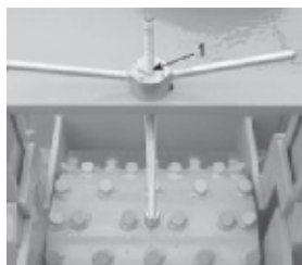
Foto 24 : Supporto tirante montato su rullo superiore (pos. 1)
