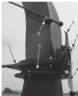
Foto 6: posizione del magnete con sicurezza inserita
