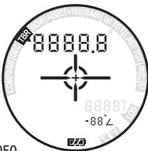
La lettura dell'inclinometro è visualizzata sotto la lettura LOS o della temperatura, secondo quale sia attivata. La lettura dell'inclinometro non è disponibile quando la modalità TBR è disattivata.
