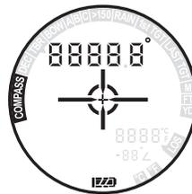
**NOTA:** la taratura della bussola deve essere effettuata quando si usa il telemetro per la prima volta o ogni volta che lo si usa in una nuova regione – per la procedura di taratura vedi Funzione N. 17.
