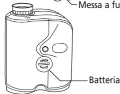
I modelli RX-I e RX-II hanno due pulsanti: ON/OFF / IMPOSTAZIONE e MODALITÀ. I modelli RX-III, RX-IV e RX-IV Boone and Crockett™ hanno tre pulsanti: ON/OFF, MODALITÀ e IMPOSTAZIONE. Per selezionare alternativamente la modalità di avvio rapido o la modalità avanzata, premere e mantenere premuti tutti i pulsanti per 10 secondi.
