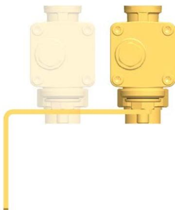
Se possibile, scegliere i fori di fissaggio più lontani rispetto al muro. In tal modo è possibile montare facilmente l'isolamento del collettore modulare.
