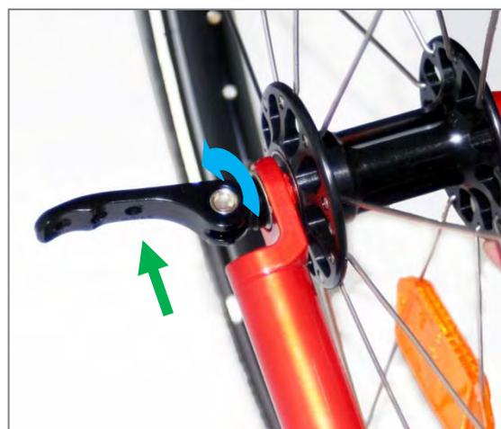
Figura 6: Apertura e rotazione dello sblocco rapido
