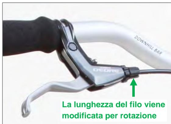
Figura 2: Leva del freno con possibilità di regolazione della lunghezza del filo
