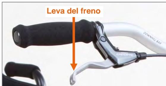
Figura 1: Leva del freno
