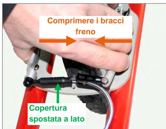
Figura 3: Copertura spostata a lato e comprimere i bracci freno
