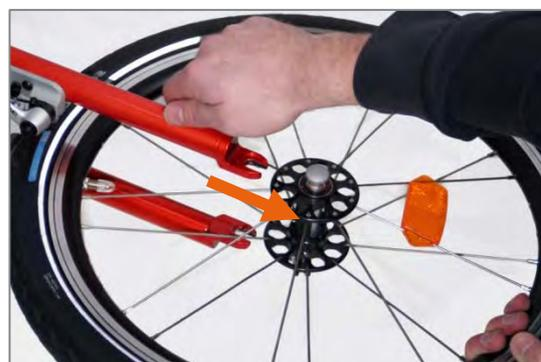
Figura 7: Estrazione della ruota verso il basso
