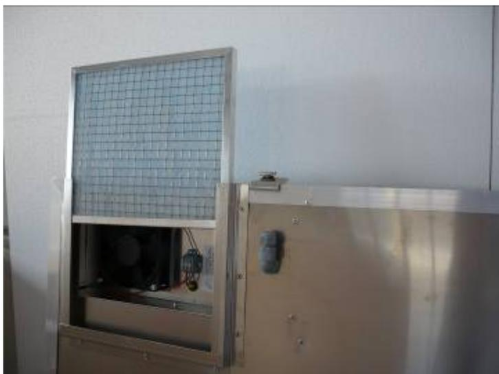
Per consentire al telaio del filtro di essere sfilato allentare il dado di fissaggio della morsa e farla slittare nella scanalatura della cornice
