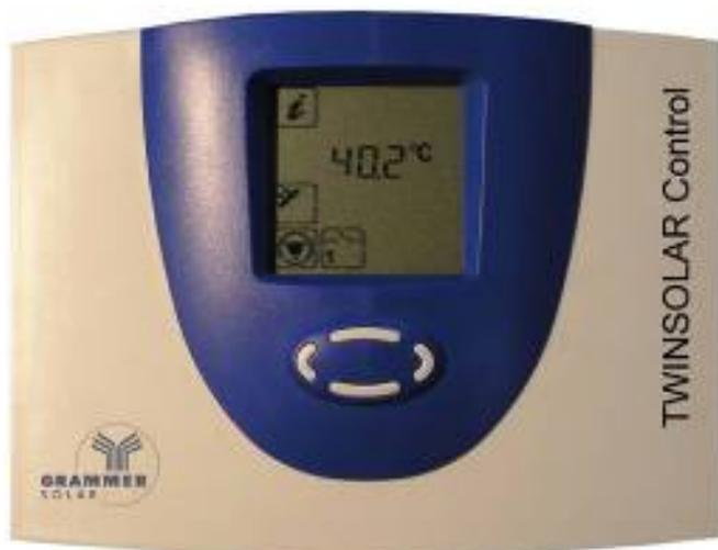
Con il tasto a destra è possibile mettere in esercizio manualmente il ventilatore (solo con una potenza del pannello fotovoltaico sufficiente!)
