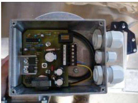
**Fig. 4-5: Ventilatore per TWINSOLAR con APW integrato**
