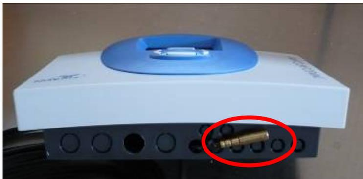
Nel caso non si volesse rilevare la temperatura nel punto in cui è posizionata la centralina ma in un'altra zona è possibile collegare al regolatore una sonda ambiente esterna. Per effettuare questa variazione vedere il manuale di installazione.
