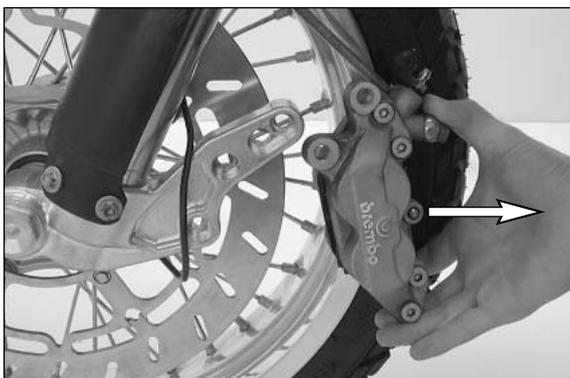
Dopo avere montato la ruota anteriore, pulire con un prodotto specifico spingere la filettatura delle due viti [4] ed applicare Loctite 243, montare le viti e serrarle con 40 Nm.
