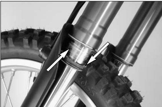
Pulire con cura i raschiapolvere, i tubi esterni e gli steli ed oliarli bene con Olio spray universale (Motorex Joker 440) o con olio motore. Infine spingere a mano i raschiapolvere nei tubi esterni.
