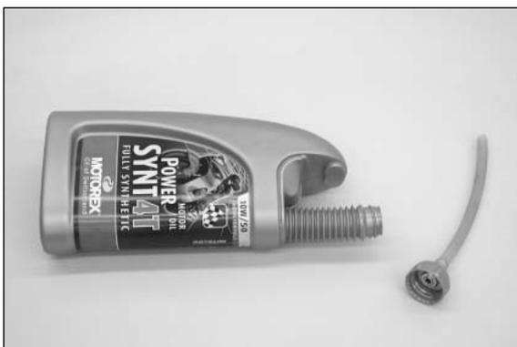
Per facilitarvi lo spurgo del sistema dell'olio abbiamo accluso agli attrezzi di bordo un raccordo per tubi ed un tubo flessibile di plastica per la costruzione di un attrezzo per il riempimento. Prendete un contenitore d'olio vuoto (da 1 litro) ed eseguite un foro 7mm nel tappo di chiusura. Avvitare il raccordo dall'esterno nel tappo di chiusura e fissatelo dall'interno con il dado esagonale M8. Montate il tubo di plastica sul raccordo.
