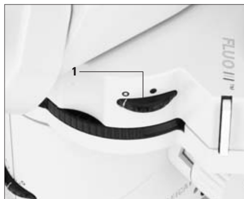
Fig. 7 1 Interruttore di attivazione/disattivazione dell'otturatore UV
