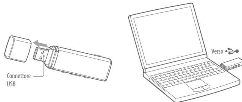
Quando l'indicatore della durata residua della batteria indica **Full**, significa che la carica è completa. Se il lettore viene utilizzato per la prima volta oppure se non è stato utilizzato per un lungo periodo, ricaricarlo completamente finché sullo schermo non viene visualizzata l'indicazione **Full**. La carica richiede circa 60 minuti qualora la batteria sia completamente scarica.
