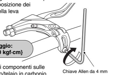
Quando si installano i componenti sulle superfici del manubrio/telaio in carbonio, verificare con il produttore delle parti/telaio in carbonio i livelli raccomandati per la coppia di serraggio, in modo da prevenire un eccessivo serraggio che potrebbe danneggiare il materiale in carbonio e/o un serraggio insufficiente che potrebbe determinare un fissaggio inadeguato dei componenti.
