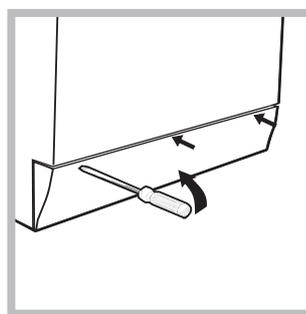
1. rimuovere il pannello di copertura sul lato anteriore della lavabiancheria con l'aiuto di un giravite (vedi figura);
