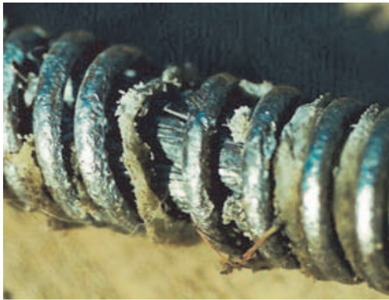
Fig. n. 22: Braca con rivestimento rotto (deve essere sostituita).
