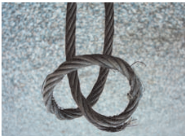
Fig. n. 16: Braca deformata e danneggiata
