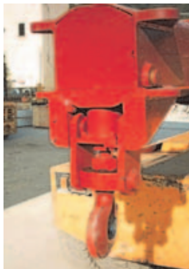
Fig. n. 14: dettaglio gancio a rotazione comandata
