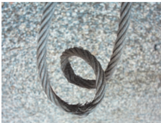
Fig. n. 19: Braca attorcigliata e con fili rotti e sporgenti
