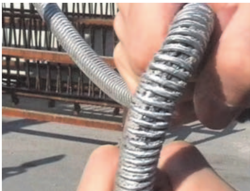
Fig. n. 24: Fune visibile sotto la protezione
