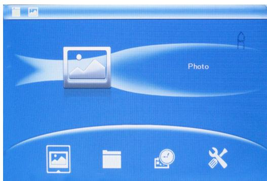
Questa cornice digitale supporta schede di memoria in formato SD, SDHC e MMC, e dispositivi di memoria dotati di interfaccia USB 2.0. Dopo che si è inserita una scheda di memoria o che si è collegato un dispositivo USB, ha automaticamente inizio la riproduzione in sequenza. Per accedere alle varie modalità operative premere il pulsante EXIT, quindi premere il pulsante ►|| per confermare
