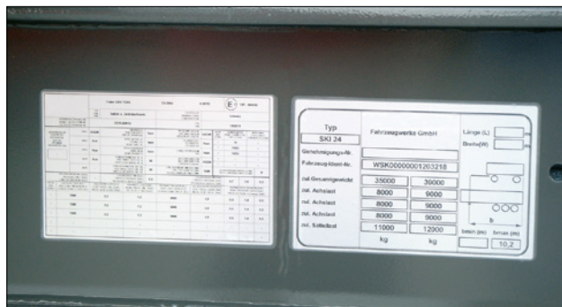
Etichetta d'identificazione con lamina protettiva su di un carrello HGV.
