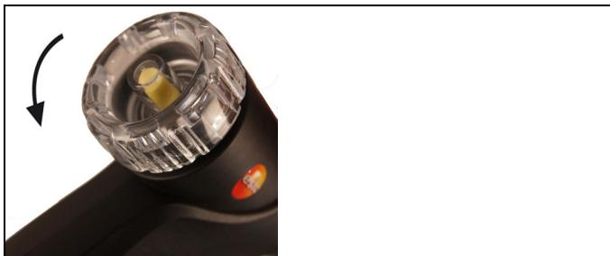
1. Aprire la camera del filtro della sonda per fumi: ruotare delicatamente in senso antiorario.
