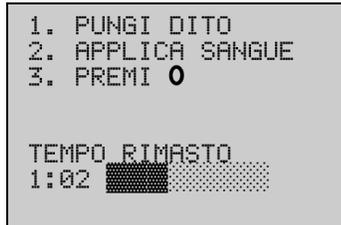
**ATTENZIONE!** Il prelievo del sangue deve essere completato entro 2 minuti 10 secondi per impedire la coagulazione precoce del campione. Il ProTime conteggia il tempo trascorso. Se trascorrono più di 2 minuti 10 secondi senza che sia stato premuto il pulsante , viene visualizzato il messaggio di errore TEMPO SCADUTO. Per eseguire un altro test, ripetere la procedura a partire dal passo 2.
