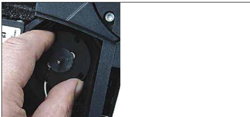
4. Smontare il motore della pompa condensa (ruotare brevemente in senso antiorario).
