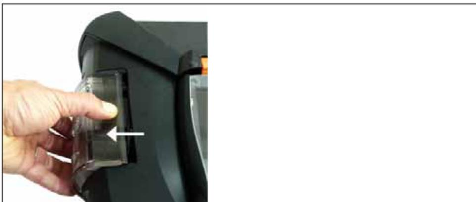
2. Sbloccare il raccogliatore per condensa e sfilarlo dall'unità di analisi tenendolo in posizione orizzontale.
