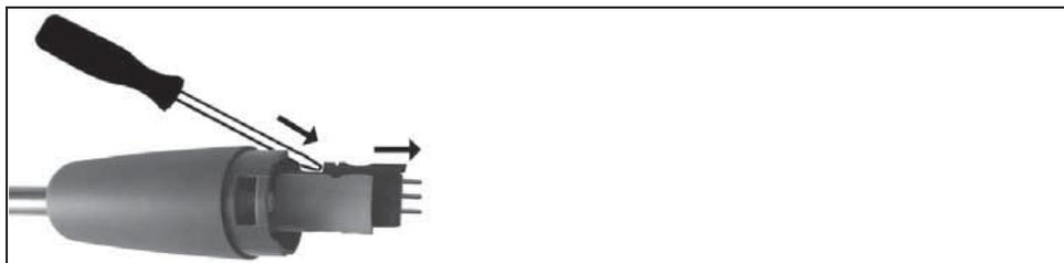
2. Con l'ausilio di un cacciavite, staccare la testa a innesto della termocoppia dalla sua sede e sfilare la termocoppia dal tubo della sonda
