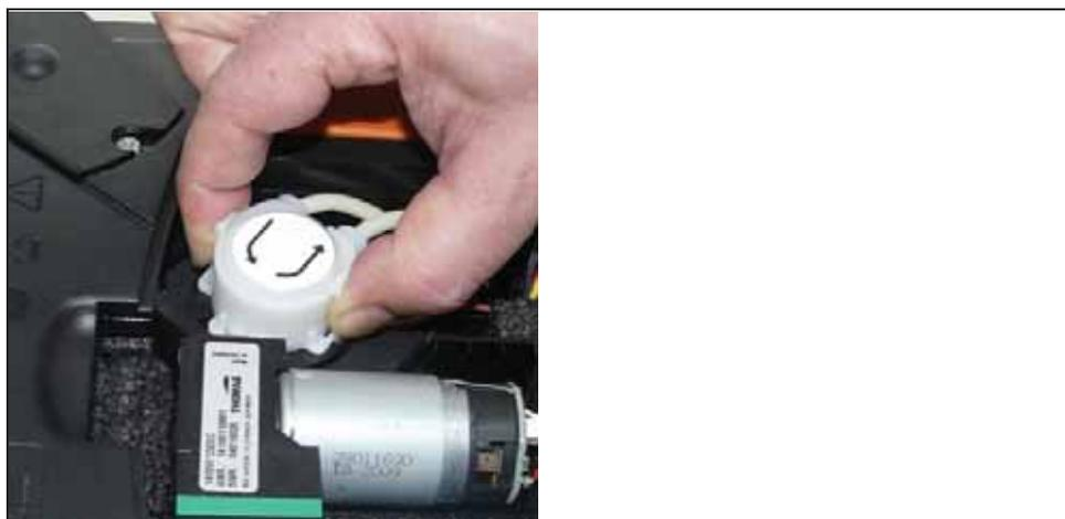
2. Disimpegnare le due chiusure laterali della pompa ed estrarre la testata della pompa.
