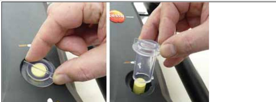
1. Aprire la camera del filtro: Ruotare il coperchio del filtro in senso antiorario e rimuoverlo.
