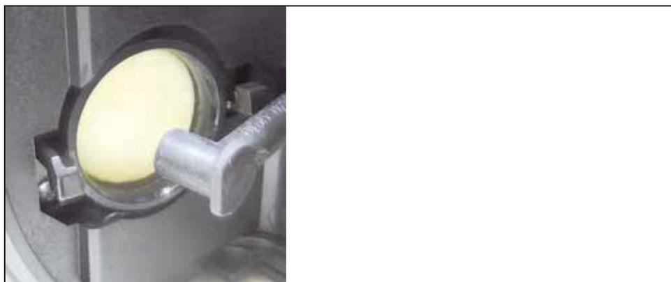
4. Sostituire il filtro intasato con un filtro nuovo.
