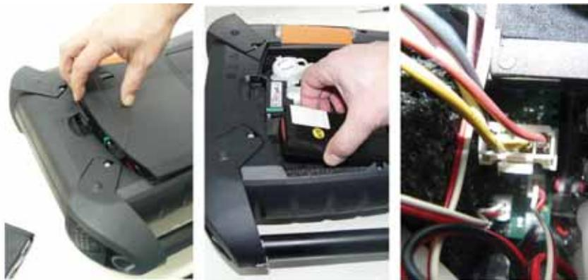
1. Aprire il coperchio del vano di manutenzione (chiusura a scatto) sul retro dell'unità di analisi.
