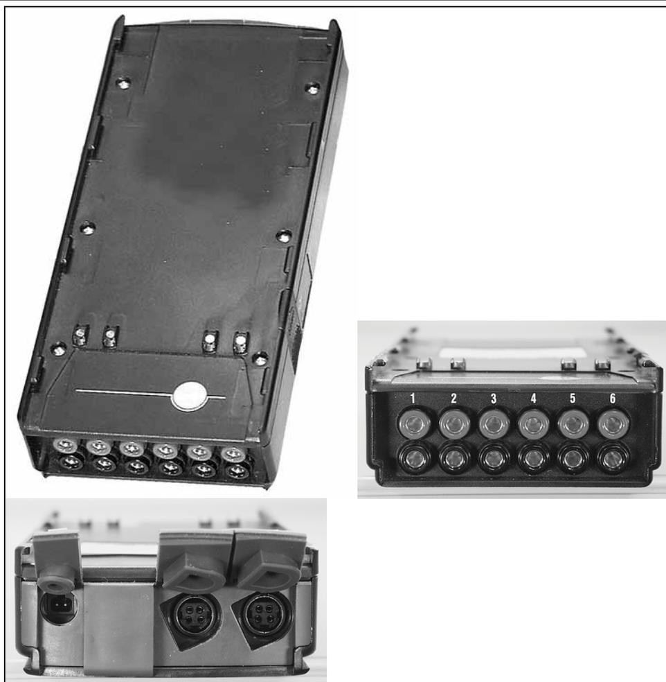
Con l'unità uscita analogica 0554 0845 (accessorio) è possibile trasmettere sino a 6 canali di misura sotto forma di segnali analogici (da 4 a 20mA). L'unità uscita analogica viene collegata allo strumento attraverso il bus dati, mentre la configurazione avviene tramite la Control Unit o il software per PC easyEmission (con controller bus dati Testo).
