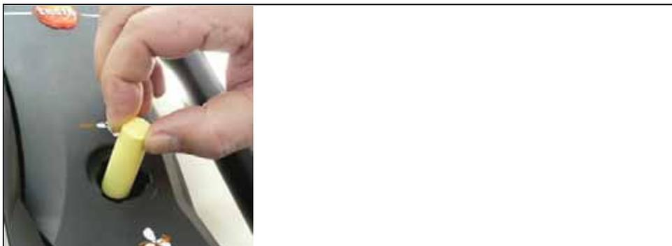
2. Estrarre il filtro intasato e sostituirlo con un filtro nuovo (0554 3381).
