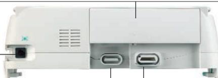
Connettore P2 per collegamento alla rete elettrica, Cavo Ambulanza (12 V), SpaceStation, tasto PCA, Cavi Accessori (allarme centrale, servizio).
