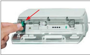
Inserire la clamp anti flusso-libero (freccia rossa) nella fessura, nella direzione indicata dalla freccia, fino a quando la leva di apertura si blocca e la clamp di sicurezza stringe la linea (viene attivato un segnale lampeggiante).
