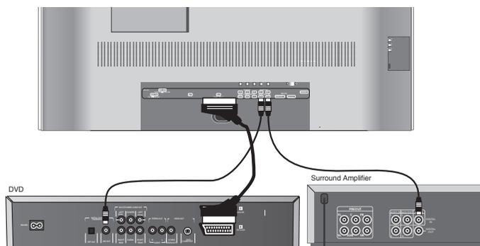
Collegare con un cavo Cinch la presa di uscita del lettore DVD (DIG OUT) con la presa "AUDIO DIGITAL IN" dell'apparecchio TV. Specificare nell'assistente di collegamento che la trasmissione del segnale audio deve essere digitale. Specificare che l'audio digitale deve essere assegnato, ad esempio, alla presa Euro AV 2, per consentirne la trasmissione all'uscita audio digitale dell'apparecchio TV e, attraverso di essa, agli amplificatori esterni. Ulteriori informazioni in merito a pagina 26.
