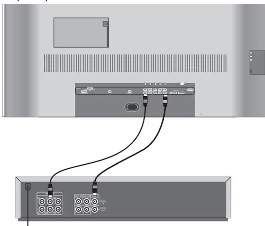
Per gli **amplificatori audio analogici**, selezionare sotto "Trasferimento audio" la voce "Analogico". L'audio per l'amplificatore analogico viene trasmesso all'amplificatore audio attraverso i collegamenti AUDIO OUT L/R dell'apparecchio TV. Mediante due cavi Cinch realizzare un collegamento all'amplificatore.
