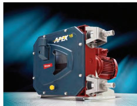
lità. Mentre APEX offre prestazioni ottime per i trasferimenti a flusso ridotto, se i requisiti per il processo cambiano, è possibile effettuare dei semplici aggiornamenti senza dover acquistare una nuova pompa. Questo perché i modelli APEX sono tre pompe in una, con un singolo corpo pompa regolabile per tre dimensioni del tubo (10, 15 e 20 mm a seconda dei volumi di produzione richiesti).
