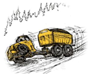
Tutti i mezzi con rischio di ribaltamento devono essere dotati di cabina **ROPS** (Roll Over Protective Structure), cioè di una cabina progettata e costruita con una struttura atta a resistere a più ribaltamenti completi del mezzo.
