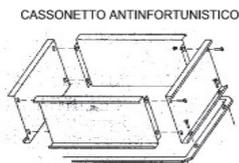
**Figura n°9 Sistema di assemblaggio del cassetto antinfortunistico**
