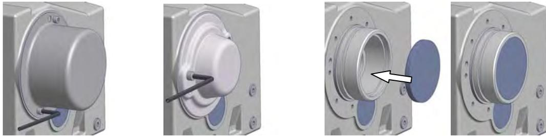
Figura 3-12: Montaggio del coperchio di protezione opzione SH, opzione H e opzione H66
