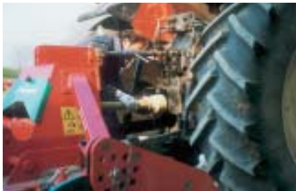
Fig. 17 - Collegamento dell'albero cardanico alla trattrice; l'albero cardanico deve essere fissato correttamente alla p.d.p. e al lato macchina rispettando il verso di rotazione e fissando le catenelle per evitare la rotazione delle protezioni.
