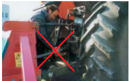
Fig. 18 - L'albero cardanico deve essere dotato di protezioni idonee per tutta la lunghezza dell'albero e dei giunti cardanici sia sull'operatrice che sulla trattrice.
