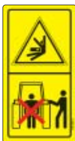
Fig. 19 - Esempi di pittogrammi. a) PERICOLO di fuori uscita di liquido in pressione b) ATTENZIONE: Stare lontano dall'area di pericolo tra l'attacco del trattore e la macchina utilizzatrice
