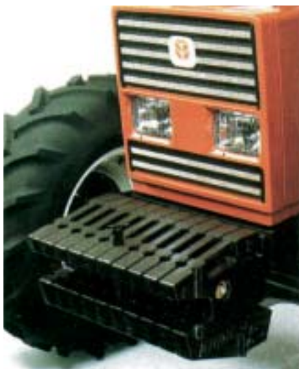
Fig. 10 - Esempio di zavorre anteriori.
