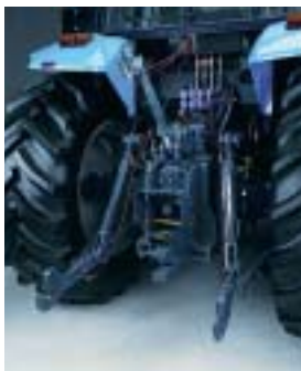
Fig. 25 - Si ricorda, per gli attrezzi portati o semiportati: l'obbligo del bloccaggio tridirezionale degli attrezzi sollevati da terra durante la circolazione stradale.
