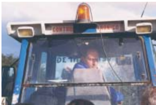
Fig. 24 - Dispositivo supplementare a luce lampeggiante arancione.
