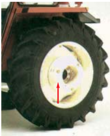
Fig. 11 - Esempio di zavorre posteriori.
