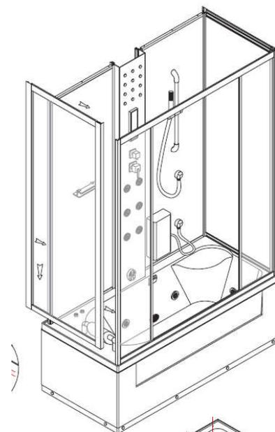
Appoggiare il tetto sopra il box e fissare con viti M4x20 sul lato posteriore e 4x16 autofilettanti sui lati laterali e frontali. Fissare pannelli posteriori sulla vasca con viti M4x30. Consigliamo di porre un filo di silicone sotto tutto il profilo tra il perimetro della vasca e la struttura di alluminio.
