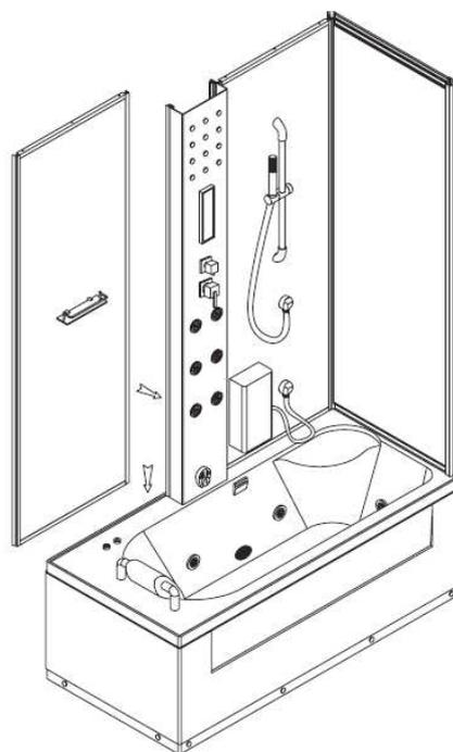
**Fase 6: Installazione del tetto.** Montare i profili di alluminio frontali come mostrato in figura stando attenti al verso dei binari orizzontali (utilizzare viti 4x25 autofilettanti)
