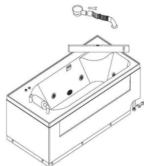
**Fase 3: Installazione del pannello laterale.** Posare il pannello laterale sulla vasca e poi con l'aiuto di un'altra persona appoggiare il pannello posteriore vicino. E fissarli assieme con viti 4x25 autofilettanti, ponendo un filo di silicone tra i due pannelli nel profilo d. contatto.
