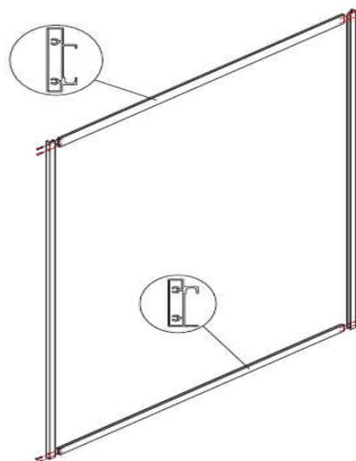
**Fase 7:** Inserite i vetri laterali destro e sinistro assicurandovi che vi sia inserita la guarnizione a "U" lungo tutto il profilo. Poi collegate i profili di alluminio con relativa guarnizione a "T", fissandoli alle corsie orizzontali tramite viti 4x16 autofilettanti. Fissare i vetri inserendo guarnizioni a spina di pesce.
