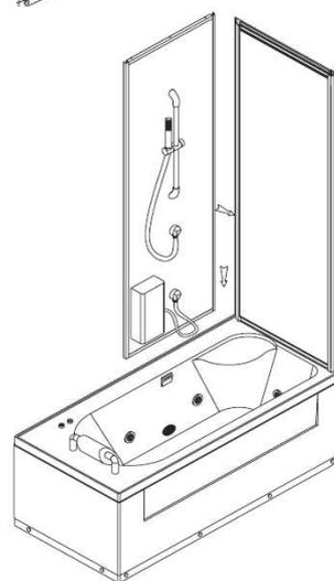
**Fase 4: Collegamento dei pannelli posteriori e della vasca.** Fissare la colonna attrezzata al pannello posteriore con viti 4x25 autofilettanti, ponendo un filo di silicone lungo il profilo di contatto.
