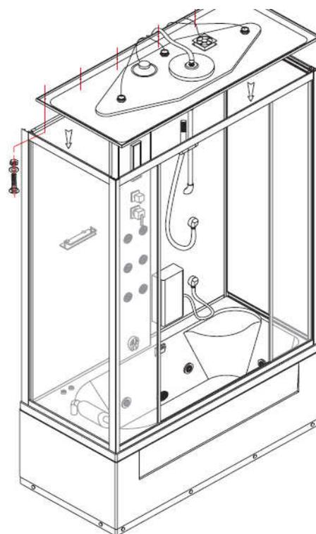
Installare le rotelline sulle antine di vetro e montarle sulle relative rotaie. Regolare le antine agendo sulla vite apposita posta sul bloccetto rotelline. Installare le maniglie e le guarnizioni magnetiche . NB: fate attenzione che sulle maniglie via sia la relativa guarnizione in gomma: non devono stringere direttamente il vetro.
