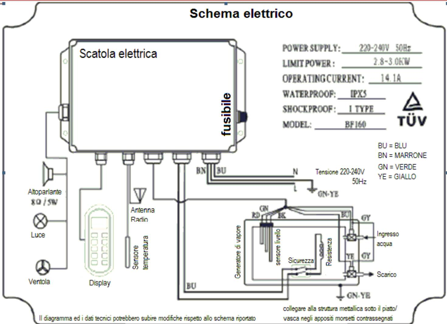
Lo schema si riferisce solamente all'impianto doccia ( l'alimentazione della pompa idromassaggio della vasca è separata )
