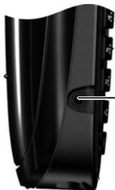
È possibile collegare un auricolare telefonico con spinotto a jack da 2,5 mm nell'apposita presa situata sul lato sinistro del portatile. Gli auricolari suggeriti sono gli HAMA, Plantronics M40 e MX100.
