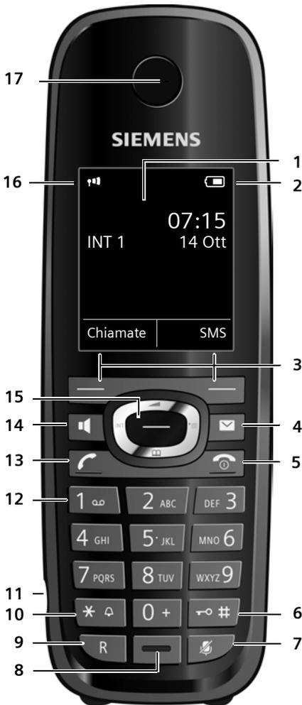
Il portatile rappresentato in figura è registrato su una base compatibile con il servizio SMS.
