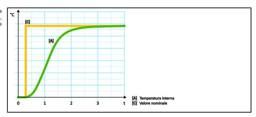
Regolazione dinamica della temperatura interna con possibile sovraoscillazione della temperatura
