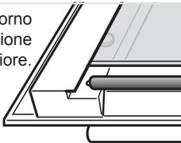
L'apertura tra la parte superiore del vetro interno e la parte superiore della porta forno è appositamente prevista per permettere la circolazione dell'aria di raffreddamento.
