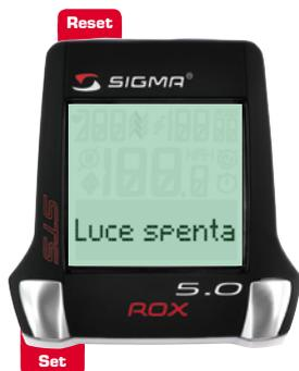
Premendo contemporaneamente i pulsanti funzione **Set** e **Reset** si attiva/disattiva la funzione di illuminazione. Sul display appare brevemente "Luce on/Luce off".
