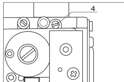
orario la vite **4** per diminuire il valore del CO<sub>2</sub> (1 di giro modifica il valore di circa 0,2-0,4 %). Dopo ogni modifica, attendere un minuto per stabilizzare il valore del CO<sub>2</sub>.
