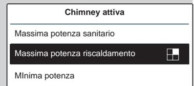
Per attivare la Funzione Spazzacamino dal Controllo Remoto è necessario accedere al parametro 270. Ruotare la manopola per selezionare ON e premere il tasto OK (Vedi paragrafo Area Tecnica)
