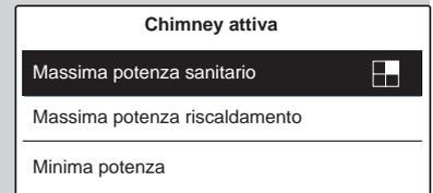
La caldaia è forzata alla Massima potenza in sanitario, il display indica la temperatura di mandata. Premere di nuovo il pulsante di reset per forzare alla potenza minima, sul display viene visualizzato alternativamente:
