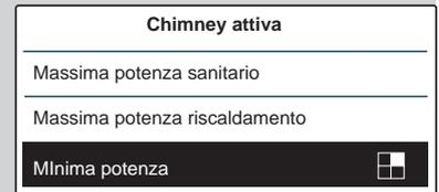
Premere di nuovo il pulsante di RESET la caldaia si attiva alla Massima potenza Riscaldamento. Sul display viene visualizzato alternativamente:
