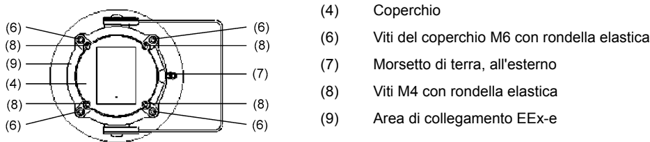
III. 2: avvisatore acustico, vista sul coperchio
