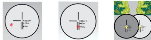
4. Usare le due viti (spostamenti laterali, in altezza) per rettificare il punto laser.
