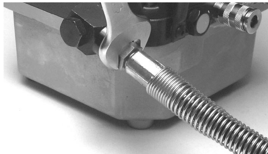
FIG. 4 PUMP POSITION FOR REPLACEMENT OF HIGH PRESSURE HOSE POSITIONNEMENT POMPE POUR LE REMPLACEMENT DU FLEXIBLE HAUTE PRESSION PUMPENPOSITION ZUM WECHSELN DES HOCHDRUCKSCHLAUCHES POSICIONAMIENTO BOMBA PARA CAMBIAR LA MANGUERA DE ALTA PRESIÓN POSIZIONAMENTO POMPA PER SOSTITUZIONE TUBO ALTA PRESSIONE
