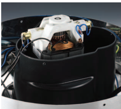
Fig. 7-4 Sostituzione delle spazzole di carbone
