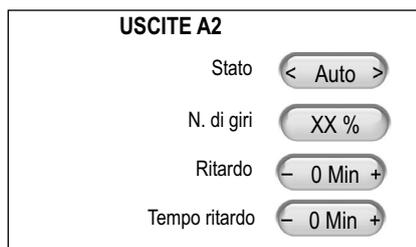
• Commutare lo «Stato» di «USCITE A2» su «On». Controllare, se la pompa dell'acqua calda entra in funzione.
