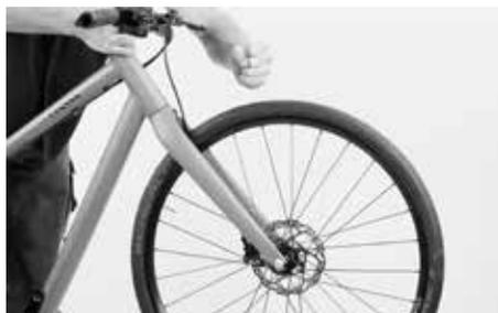
Sollevarne infine la ruota di alcuni centimetri dal suolo e dall'alto dare un colpo leggero allo pneumatico. Una ruota fissata stabilmente resta nei forcellini del telaio o della forcella e non produce rumori.
