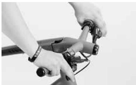
Dopo aver montato la ruota e chiuso il Wheelguard, tirare la leva del freno più volte, quindi fare girare la ruota. Il disco del freno non deve strisciare né sulla pinza né, in genere, contro le pastiglie.
