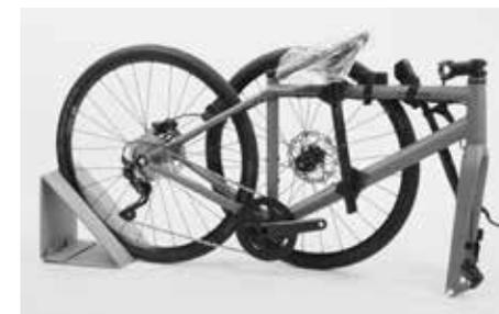
Collocare la bicicletta Urban parzialmente montata in una posizione sicura con il cartone di sostegno triangolare. Se necessario chiedere all'aiutante di tenere la bicicletta.
