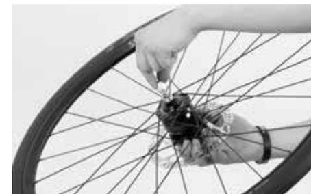
Avvitare leggermente a mano i dadi di bloccaggio del Wheelguard e montare la ruota anteriore.
