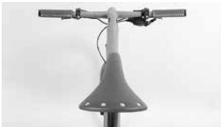
Verificare che la sella non sia storta fissando la punta lungo il tubo orizzontale
