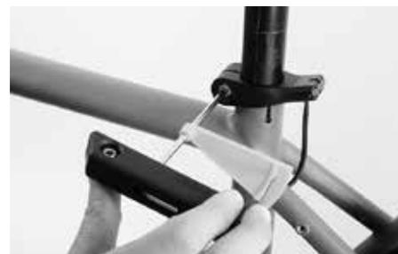
Regolare la sella e avvitare la vite sul bloccaggio rapido del reggisella, ovvero del Wheelguard, senza serrare troppo, ovvero senza superare la coppia di serraggio consentita di max. 8 Nm. Eseguire questa operazione utilizzando la chiave dinamometrica Canyon.
