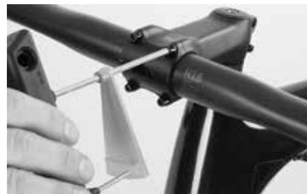
Le viti degli attacchi manubrio Canyon devono essere serrate una per una di alcuni giri utilizzando una chiave a brugola precisa e adatta allo scopo. Quindi serrare soltanto entrambe le viti superiori fino a che la fessura di fissaggio sopra è completamente chiusa.
