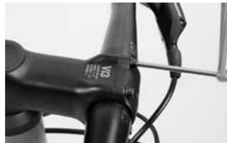
▶ Avvitate leggermente (1 Nm) entrambe le viti superiori (pos. 1+3). Le fessure devono chiudersi completamente, il coperchio frontale deve andare "in blocco". Se necessario allentate leggermente le due viti inferiori (pos. 4+2).
