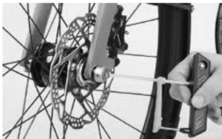
Serrare i dadi di bloccaggio con la chiave dinamometrica Canyon rispettando le indicazioni riportate sul Wheelguard. Non superare la coppia di serraggio indicata!
