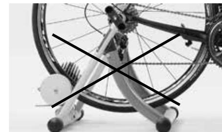
Non utilizzate una bicicletta Canyon per un allenamento dove è prevista una qualsiasi forma di bloccaggio della bici
