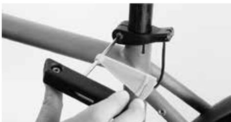
Serrare i dadi di bloccaggio con la chiave dinamometrica Canyon rispettando le indicazioni riportate sul Wheelguard
