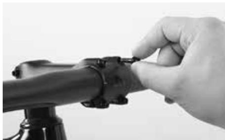
Se per far scorrere il manubrio nella zona di bloccaggio dell'attacco manubrio dovesse essere necessario usare la forza o se tra i due componenti dovesse esserci del gioco, contattate la hotline di assistenza Canyon +39 045508894 per verificare che i due componenti siano compatibili.
