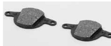
I pattini con spessore inferiore ad un millimetro devono essere sostituiti con ricambi originali
