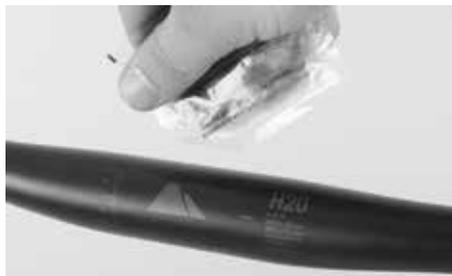
Prima di applicare la pasta di montaggio Canyon sulle superfici interessate rimuovere lo sporco e i residui di lubrificante. Successivamente spalmare sulle superfici pulite uno strato sottile e uniforme di pasta di montaggio Canyon con un pennello o un panno in pelle.
