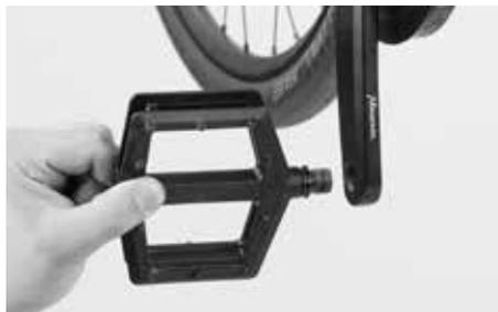
Con la mano fare girare due-tre volte i pedali fissandoli nei filetti delle pedivelle. Servirsi quindi di una chiave per pedali per fissare i pedali.
