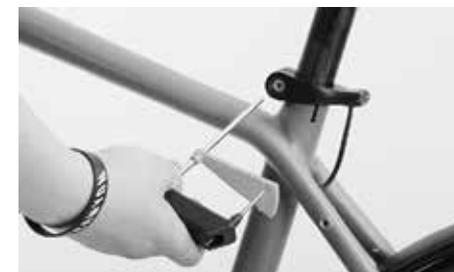
Per regolare l'altezza della sella è necessario allentare il Wheelguard dalla vite di bloccaggio del reggisella
