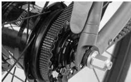
Sulle biciclette Urban con trasmissione a cinghia Gates per una corretta impostazione devono essere posizionate due marcature gialle di allineamento a destra del mozzo regolando il cavo del cambio direttamente sulla leva del cambio, come con un cambio a catena.
