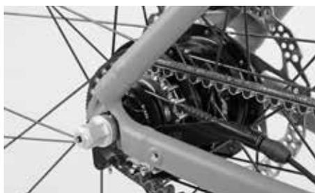
La cinghia di trasmissione Gates trasmette la potenza al mozzo
