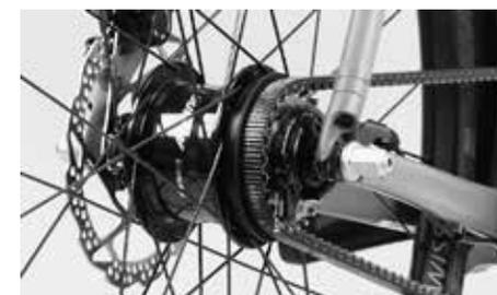
Cambio al mozzo con la cinghia di trasmissione Gates
