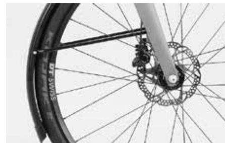
Sulla ruota anteriore il parafrangio deve essere avvitato al fissaggio sulla forcella. Serrare le viti con la chiave dinamometrica Canyon rispettando le indicazioni impresse sul componente.
