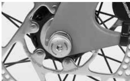
Le ruote della bicicletta Canyon Urban anziché montare i bloccaggi rapidi sono equipaggiate con i cosiddetti Wheelguard. Si tratta di un antifurto per le ruote. Una volta chiuso, infatti, il Wheelguard non può più essere aperto fintanto che la bicicletta si trova in posizione verticale.
