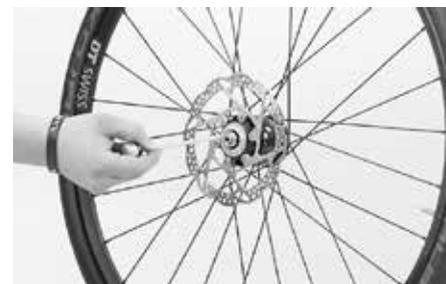
Spostare il Wheelguard nell'asse cavo della ruota. Posizionare le molle sul Wheelguard. Verificare che le molle siano rivolte verso l'asse del mozzo con il diametro ridotto.
