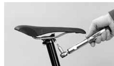
Serrare nuovamente le viti in modo alternato e uniforme con la relativa coppia di serraggio
