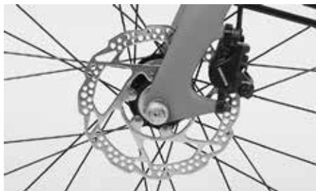
Le ruote devono essere serrate in maniera stabile
