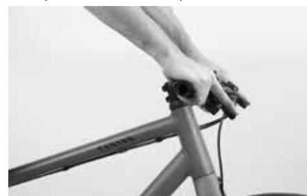
Regolare il manubrio con la ruota anteriore montata e con la pressione di gonfiaggio ottimale. Sulla bicicletta Urban pronta per la messa in strada le leve del freno sono leggermente inclinate verso il basso. Una volta in sella, con le dita appoggiate sulla leva del freno, le braccia distese e le dita devono formare una linea retta.
