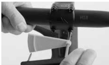
Svitare la vite (le viti) ad esagono incassato sul lato anteriore dell'attacco manubrio
