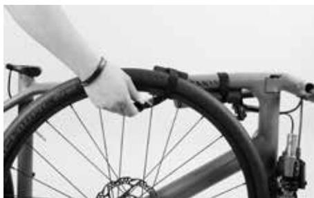
Allentare con cautela il nastro con il velcro che fissa la ruota anteriore al telaio e appoggiare con attenzione la ruota anteriore.
