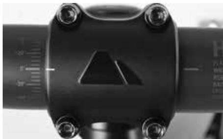
Montare il nuovo manubrio Canyon in modo che sia centrato sulla zona di bloccaggio del manubrio e che vi sia la stessa lunghezza su entrambi i lati dell'attacco. La posizione centrale è riconoscibile dalle marcature sul manubrio.
