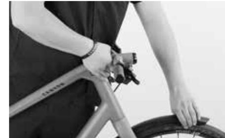
Dopo aver montato la ruota e chiuso il Wheelguard, tirare la leva del freno più volte, quindi fare girare la ruota.
