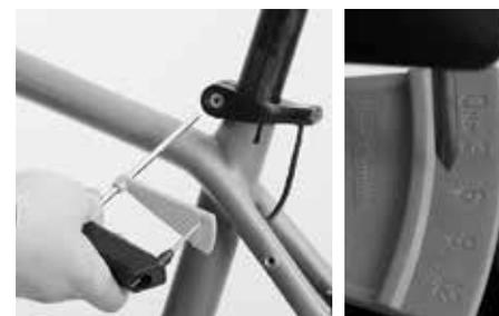
Girare lentamente tenendo la chiave dinamometrica Canyon dall'impugnatura. Quando la vite è serrata, l'indicatore sulla scala si sposta. Sospendete di girare la chiave non appena l'indicatore raggiunge il valore della coppia di serraggio prescritta.
