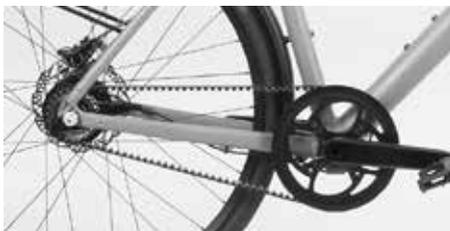
Trasmissione a cinghia Gates con cambio al mozzo
