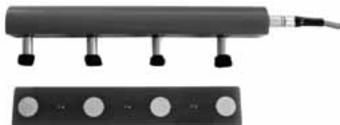
Fig. 7.1 Sonda quadripolare Wenner con cavo e piastra di controllo
