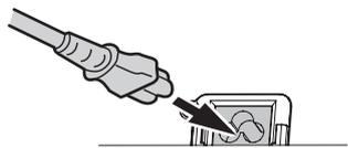
2. Allineare il lato del blocco di sicurezza del cavo di alimentazione con la guida a incastro del terminale **AC IN** del proiettore e infilarlo.
