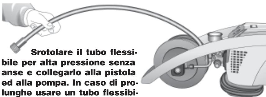
**Srotolare il tubo flessibile per alta pressione senza anse e collegarlo alla pistola ed alla pompa. In caso di prolunghe usare un tubo flessibile per alta pressione di max. 20m oppure 2 di 10m con raccordi per tubi flessibili.**
