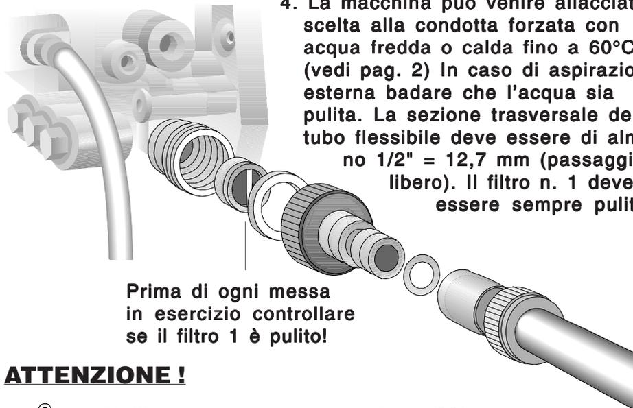
4. La macchina può venire allacciata a scelta alla condotta forzata con acqua fredda o calda fino a 60°C. (vedi pag. 2) In caso di aspirazione esterna badare che l'acqua sia pulita. La sezione trasversale del tubo flessibile deve essere di almeno 1/2" = 12,7 mm (passaggio libero). Il filtro n. 1 deve essere sempre pulito.
