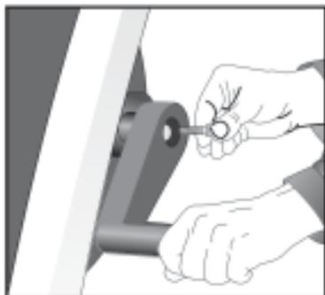
Alzare la pulitrice ad alta pressione. Svitare le vite dalla parte di ottone. Innestare la manovella sull'esagono e fissarla con la vite.
