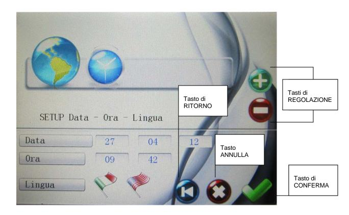
Per cambiare i dati, aiutarsi con i tasti di regolazione. Una volta impostati i parametri, confermare per tornare alla schermata iniziale.
