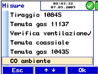
Figura 60: Prova di tenuta scarico sdoppiato con CO ambiente
