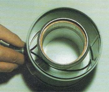
Figura 53: Sonda speciale multiforo
