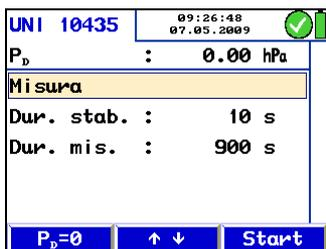
Fig. 71: Misura della tenuta
