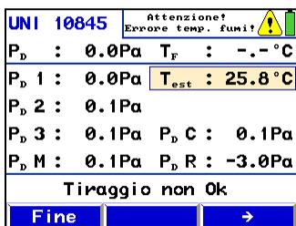
Figura 45: Fine della misura tiraggio
