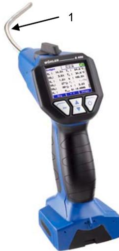
Figura 2: Wöhler A 400 con sonda flessibile
