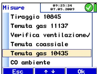
Figura 69: Tenuta impianto gas di centrale termica
