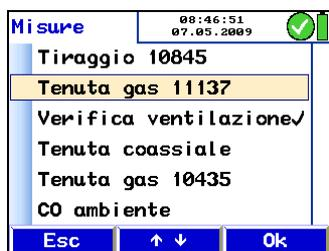
Figura 63: Prova di tenuta U I 11137
