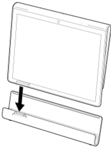
5. Inserire il tablet nell'alloggiamento superiore della base con ricarica.
